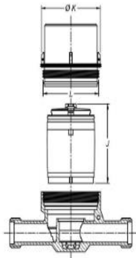
Figura 9. Medidor con módulo metrologicamente intercambiable. Esquema de flujo concéntrico, inferencial
