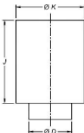
Figura 3. Dimensiones de medidores concéntricos y medidores cartucho
